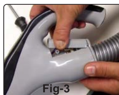
Fig-3. Demontera locket enligt bilden.
