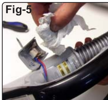
Fig-5. Rengör kontaktytorna noggrant med kemiskt ren bensin eller något liknande. Du kan vid behov använda ett fint sandpapper för att borsta upp ytorna. Rengör även släpskorna under locket på samma sätt.
