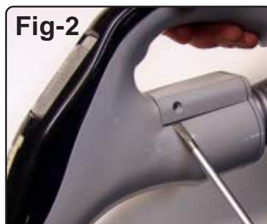
Fig-2. Använd en plan-skruvmejsel och bryt försiktigt upp locket.
